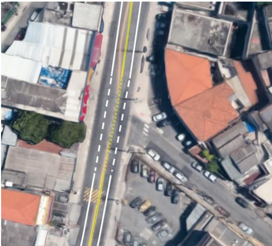
Figura 4.21 - Representação de faixas de ônibus após implementação sugerida. Trecho 6 Bairro-Centro e Trechos 4 e 3 Centro-Bairro (Av. Maria Coelho Aguiar No. 1000 a 850)
