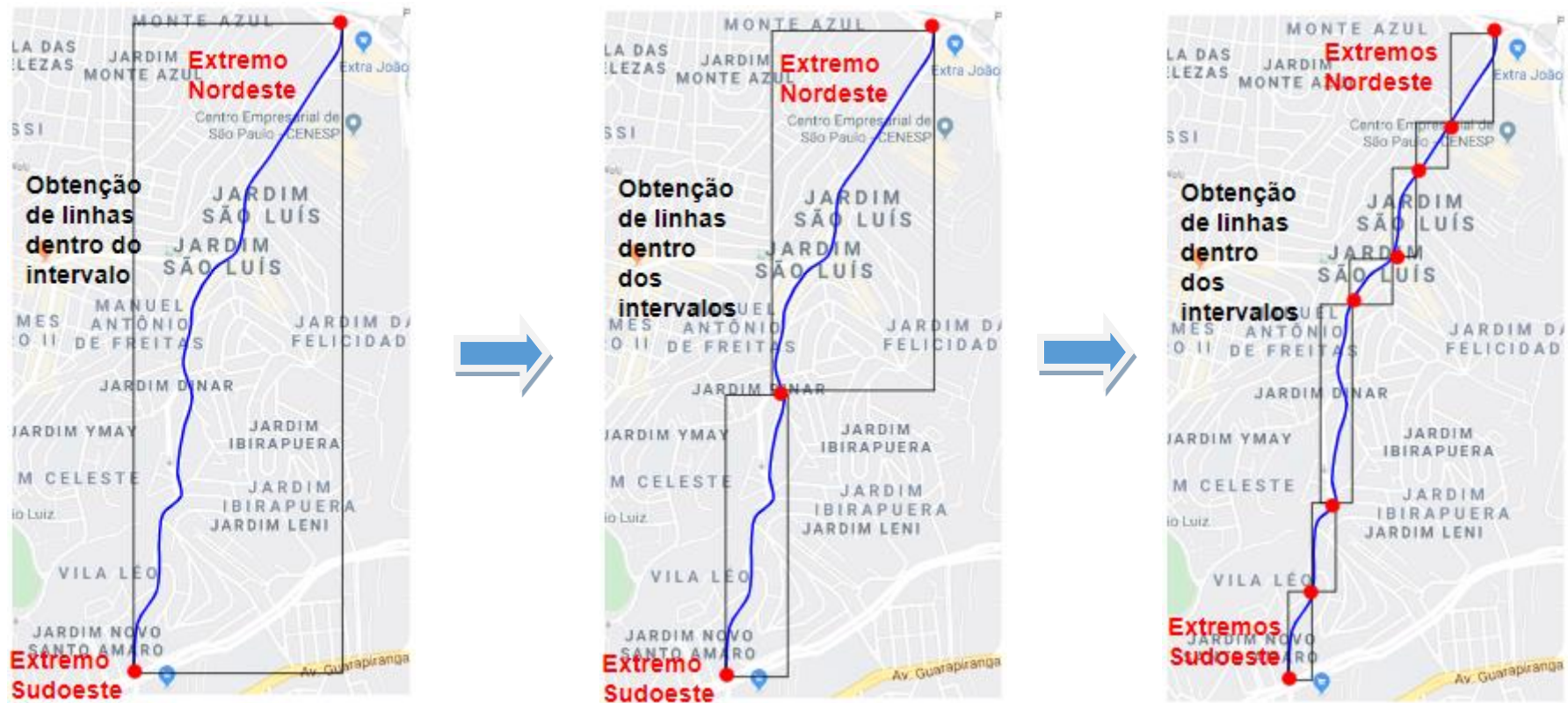
Figura 3.9 - Refinamento de subdivisões da avenida para localização das medições GPS situadas nos intervalos
