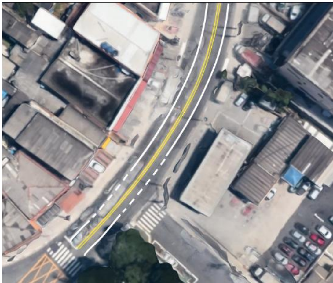
Figura 4.20 - Representação de faixas de ônibus após implementação sugerida. Trecho 6 Bairro-Centro e Trecho 4 Centro-Bairro (Av. Maria Coelho Aguiar No. 1000 a 900)
