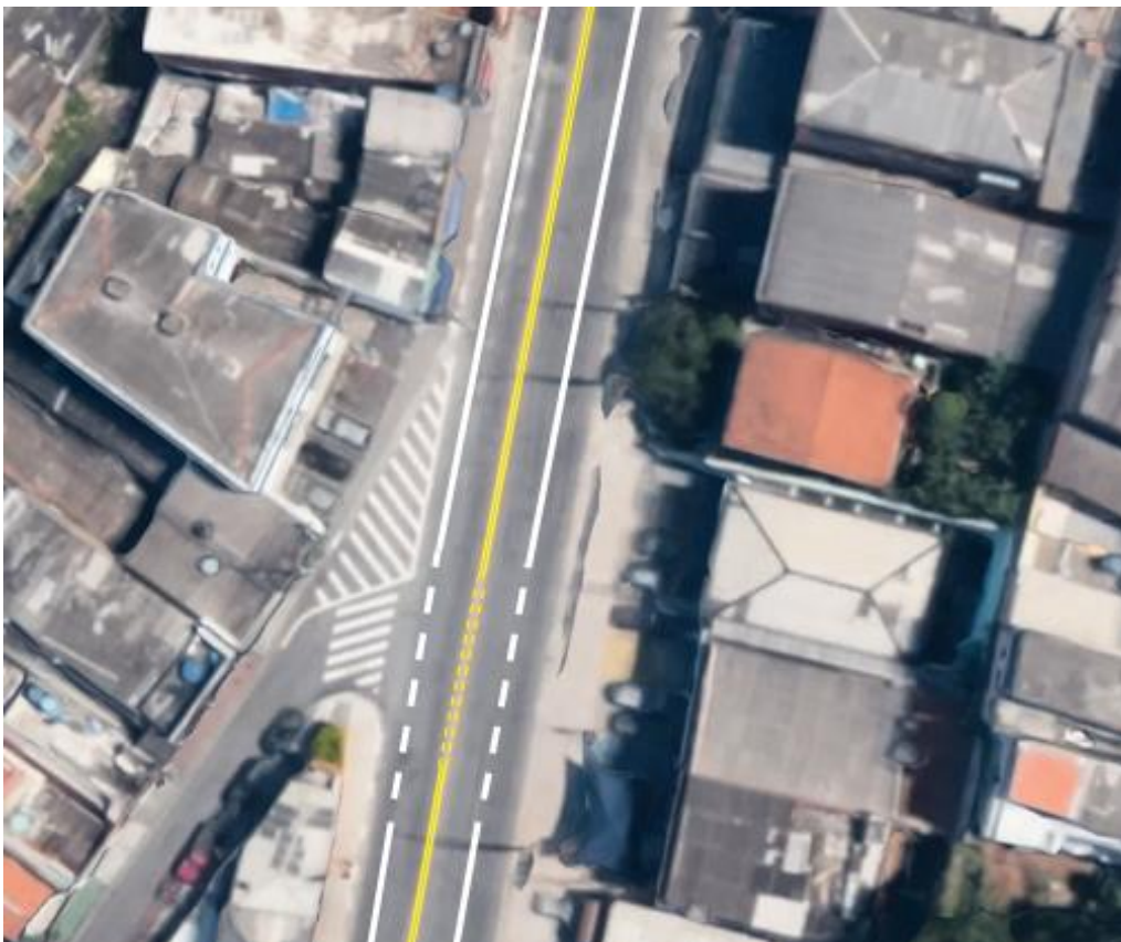
Figura 4.22 - Representação de faixas de ônibus após implementação sugerida. Trecho 6 Bairro-Centro e Trecho 3 Centro-Bairro (Av. Maria Coelho Aguiar No. 850 a 750)
