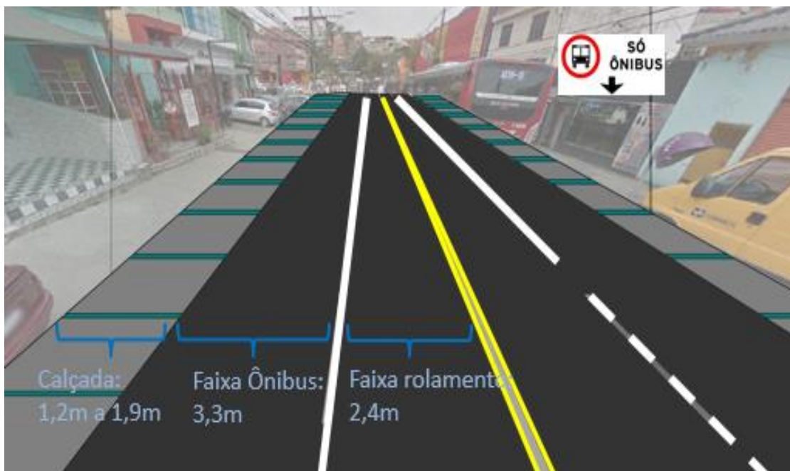
Figura 4.18 - Representação da solução para as faixas automotivas em perspectiva
